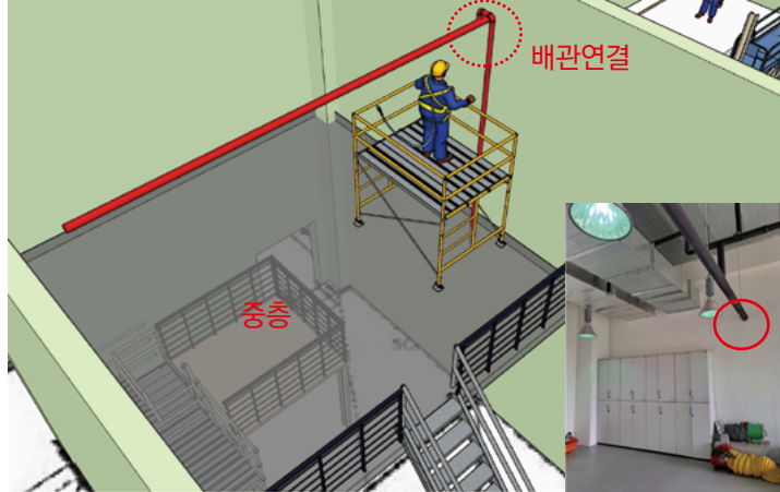
00 실습실 상부 배관 연결
